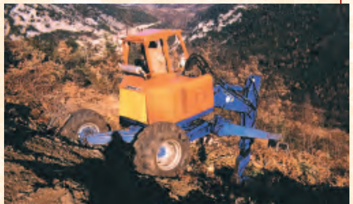
Travail du sol en forte pente : réalisation de potets individuels à la pelle araignée.
